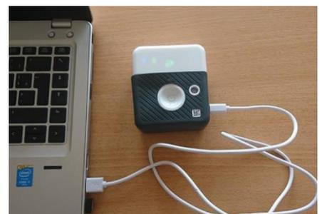
**Solution 3 :** Si les précédentes solutions ne fonctionnent pas, il est conseillé d'appuyer sur le bouton RESET caché derrière la chaussette sur la face avant. Il est possible d'enlever complètement la chaussette ou simplement de dégager l'espace nécessaire pour avoir accès au bouton RESET. Cette action démarrera le capteur s'il est initialement éteint et redémarrera le capteur s'il est initialement allumé.
